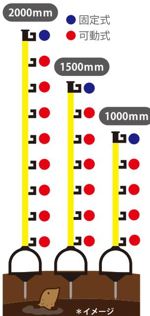
取り付け、取り外し、段数や間隔の調整も簡単 獣害対策のための固定具・ポール一体型。
